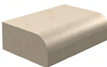
Kante R2 Rundung oben 15 mm und unten 3 mm gefast
